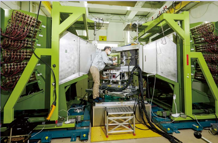
BL19 (TAKUMI) 内部での測定試料をセットしている様子。中央の大きな空間に各種装置を取り付けることで高温や極低温などの環境下で引張試験や疲労試験を行いながら中性子によってひずみ分布や構造変化を捉えることが可能である。
